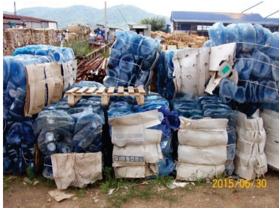
Слике 60 -62: Сакупљен, пресован и балиран отпад, спреман за испоруку овлашћеном оператеру
